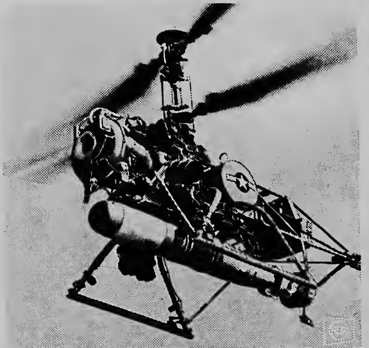
E helicopter aki ta ser poné a prueba riba laman na Long Beach, California, sin piloto a bordo. E ta transporta un torpedo di combustible solido qu ta un arma nobo di marina norteamericana. E torpedo aki por ser lansá for di un helicopter, un avion of barcu.
